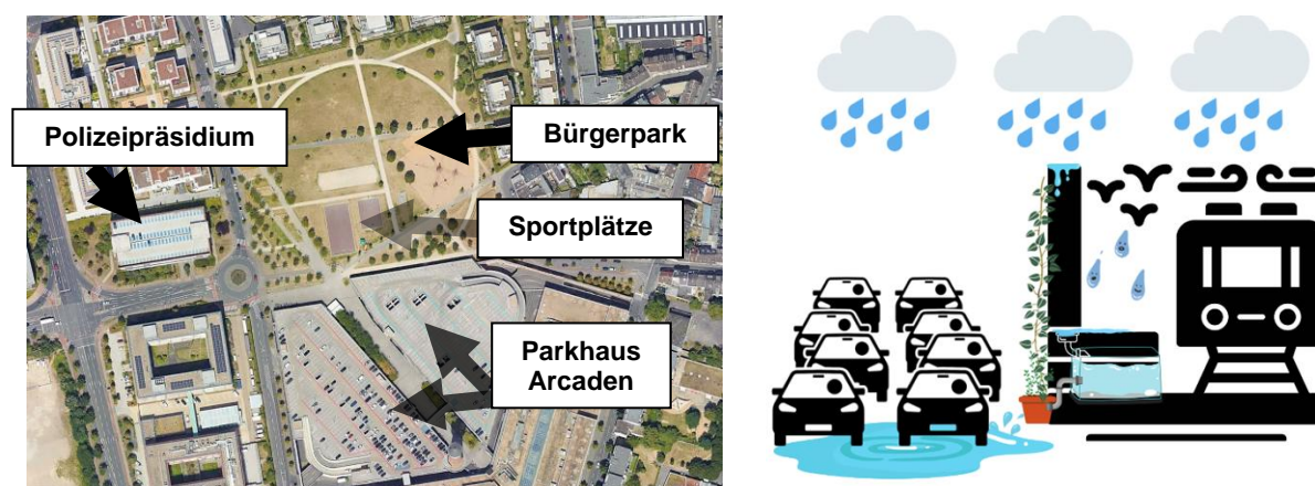
Abbildung 3-2: links: Bürgerpark Köln-Kalk samt umliegender potentieller Niederschlagsauffangflächen (Google Earth); rechts: Konzept der Speicherung und Nutzung von Niederschlagswasser zur Bewässerung von begrünten oberirdischen Bahn-Haltestellen
